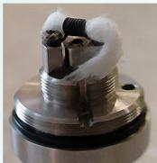
Jetzt wird durch die Spule ein Trägermedium wie z.B. Watte gezogen. Auf diese Watte wird dann das Liquid getropft. Erwärmt man nun den Draht mittels einer Stromquelle (Batterie), so beginnt die Flüssigkeit auf der Watte zu verdampfen. So einfach ist das!
